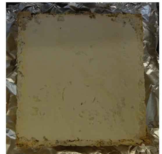
Figura 30. Prototipo de teja sin capa de PDB pero con crecimiento muy denso en una de sus caras.
