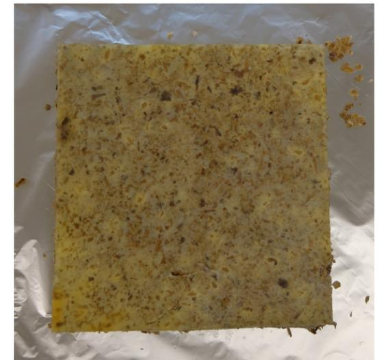
Figura 29. Prototipo de teja con capa de PDB. Se puede ver que hay crecimiento de micelio por debajo de esta primera capa de PDB, pero la capa de PDB no fue colonizada en su superficie.
