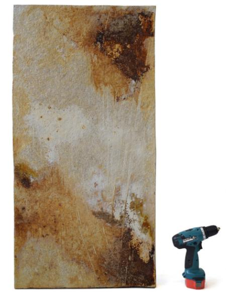
Figura 8. Panel Aislante a base de micelio de hongo. Dimensiones disponibles (aprox.): L 1200 mm x W 600 mm x H 60 mm. Grown Bio (2022).
