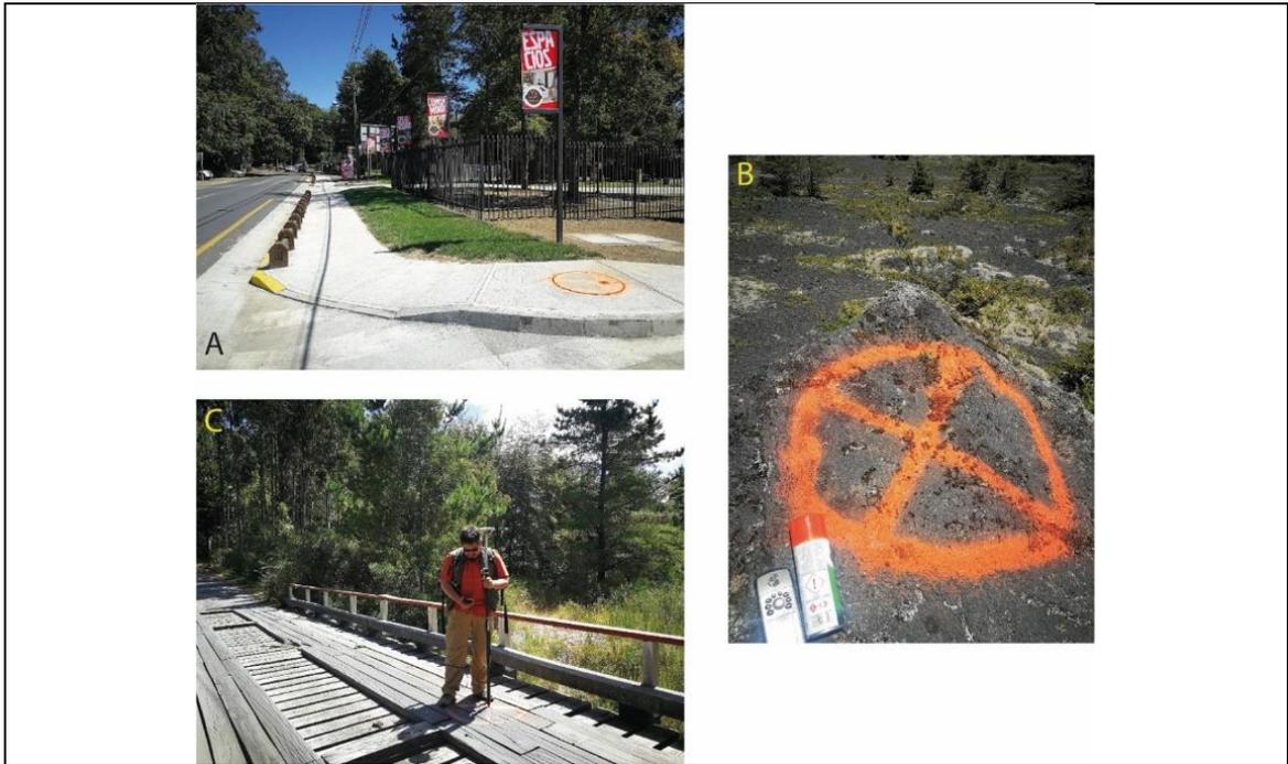
Figura 26: Puntos de control en terreno (A) Marca en zona urbana (B) Marca en zona rural (c) Toma de posición geográfica con estación móvil DGPS.
