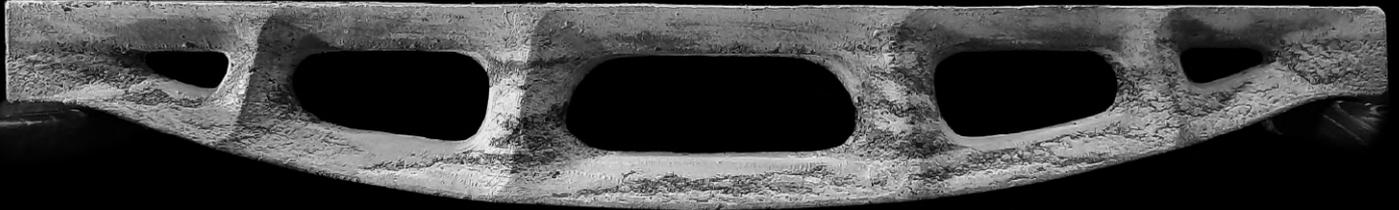
**Viga 2**, Esquema basado en investigaciones de Shakour y Amid / Moldaje por superficies curvas en trabéculas
