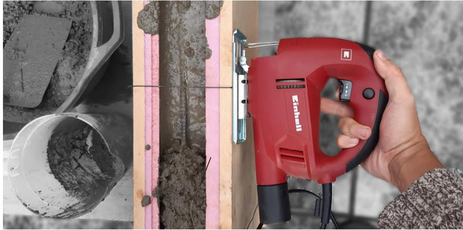
Una vez vertido el hormigón en todos los moldajes, se dejó fraguar durante 72 horas antes de su desmoldeo, al adquirir ya gran parte de su resistencia acorde a lo especificado en la NCH 170, luego de 28 días llegaría a un valor cercano de su resistencia final.
