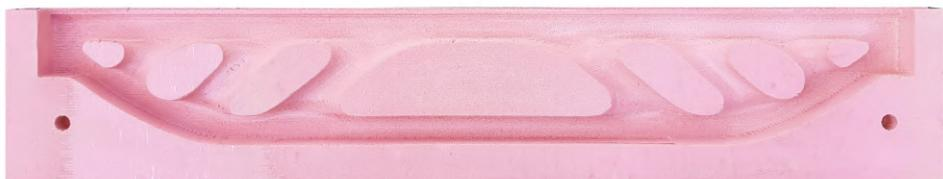
Luego de tratar las superficies, se recubrieron para sellar los poros de la espuma y se aplicó una capa de desmoldante *Topex desmol madera* para evitar la adherencia de los moldes al hormigón.
