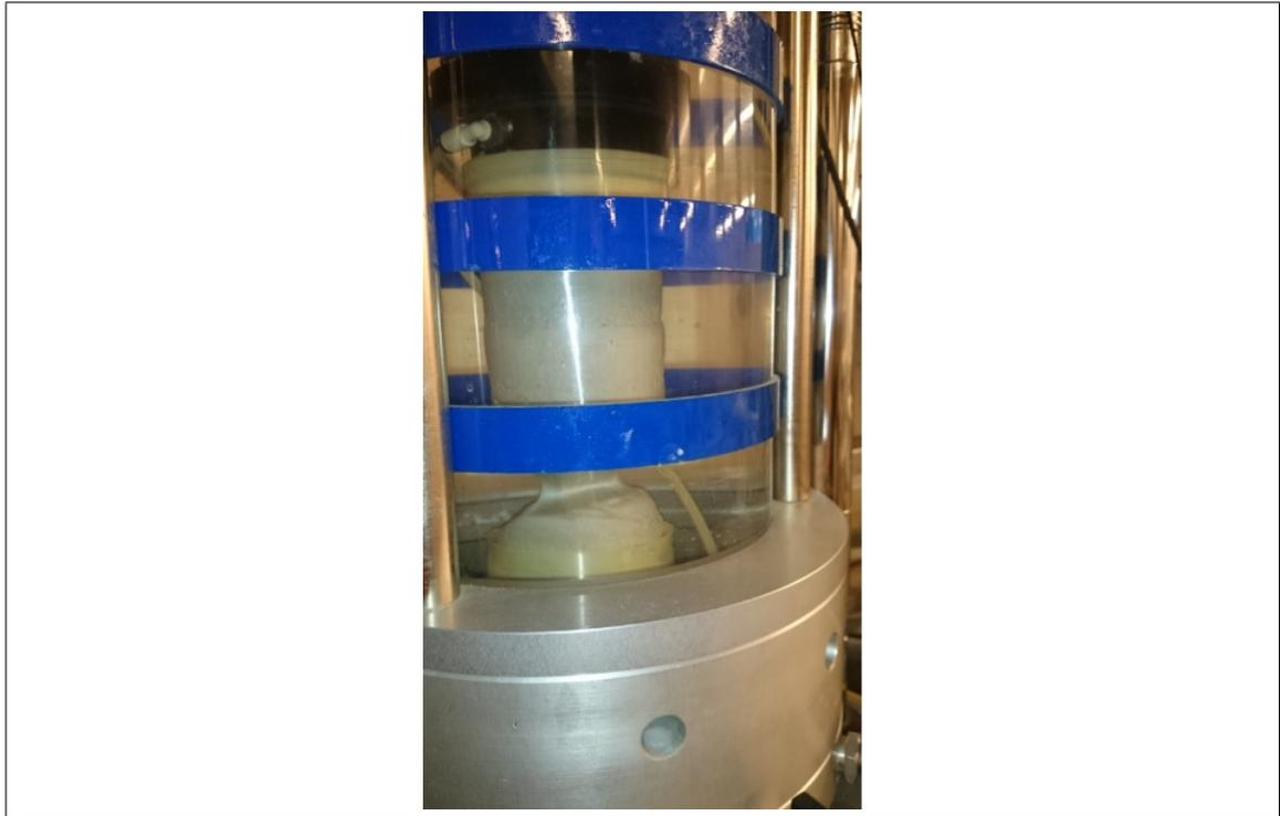
Figura 7.16. Constricción durante un ensayos triaxial monótono en extensión
