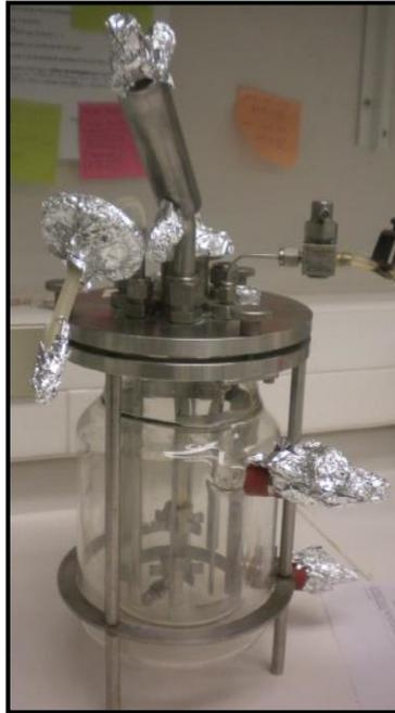
**Figura 2.** Reactor armado y autoclavado.
