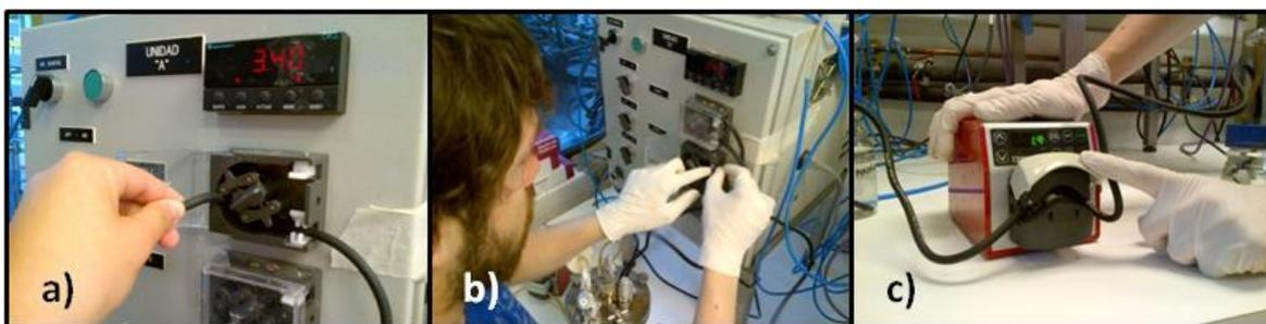
**Figura 11. A) Conexión ácido. B) Conexión base. C) Bomba peristáltica externa.**
