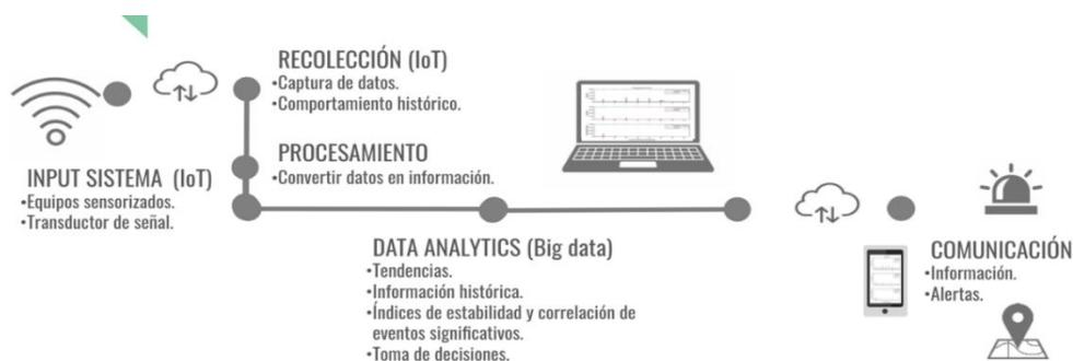
Figura 1-2: Modelo conceptual solución de monitoreo de detenciones.
