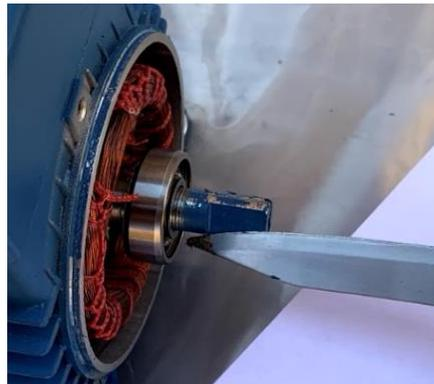
Figura 5-6: Falla de la pista interna (provocada con residuos metálicos).
