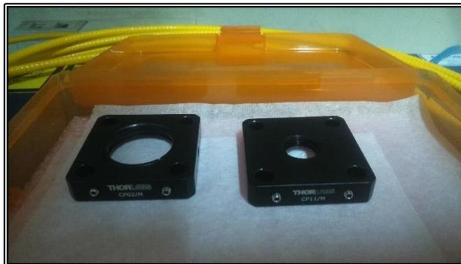
Figura 3.3. Lentes que permiten la focalización del láser.
