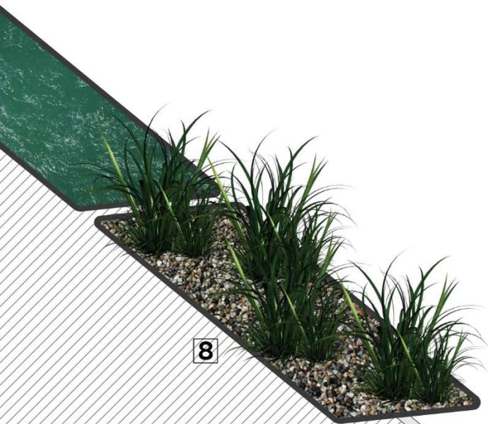
**IMAGEN 37:** PROCESO DE FITODEPURACIÓN MEDIANTE HUMEDALES FITODEPURADORES DE FLUJO SUPERFICIAL.
