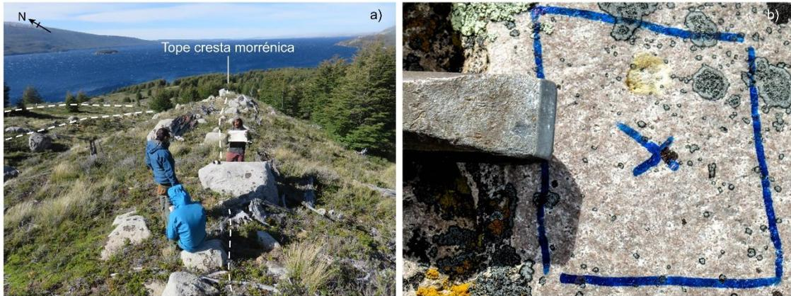
Figura 5.1: Selección de bloques morrénicos para datación mediante  $^{10}\text{Be}$ . a) Ejemplo de bloque morrénico en tope de cresta morrénica (muestra LV17-25). b) Ejemplo de superficie seleccionada para muestrear en bloque morrénico,
