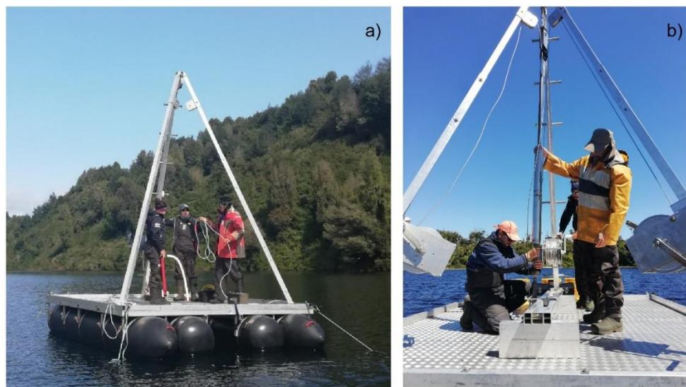
Figura 5.2: Materiales para la extracción de testigos lacustres. a) Detalle general de la plataforma UWITEC. b) Vista de la plataforma durante el procedimiento de extracción del barreno. Fotos: Einer Sepúlveda.
