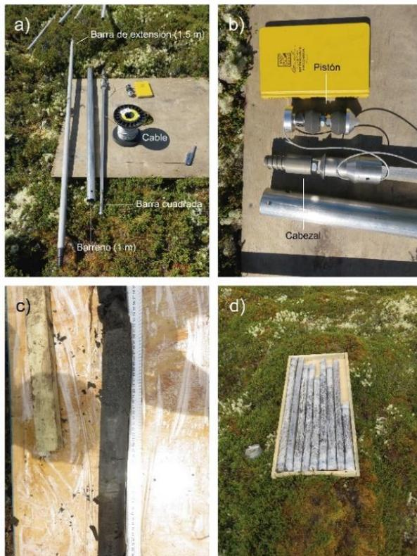
Figura 5.3: Materiales para la extracción de testigos de turberas. a) Detalle general de las partes del barreno de barra cuadrada. b) Detalle del pistón móvil de perforación, cabezal de unión de barras de extensión y barreno. c) Detalle de testigo de sedimentos de turbera mostrando una capa de tefra. d) Vista general del empaquetado y almacenado de los testigos recuperados.
