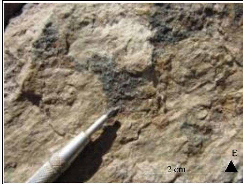
Figura 3-36: Vetilla con minerales hidrotermales alineados en actitud N20°W/64°W.
