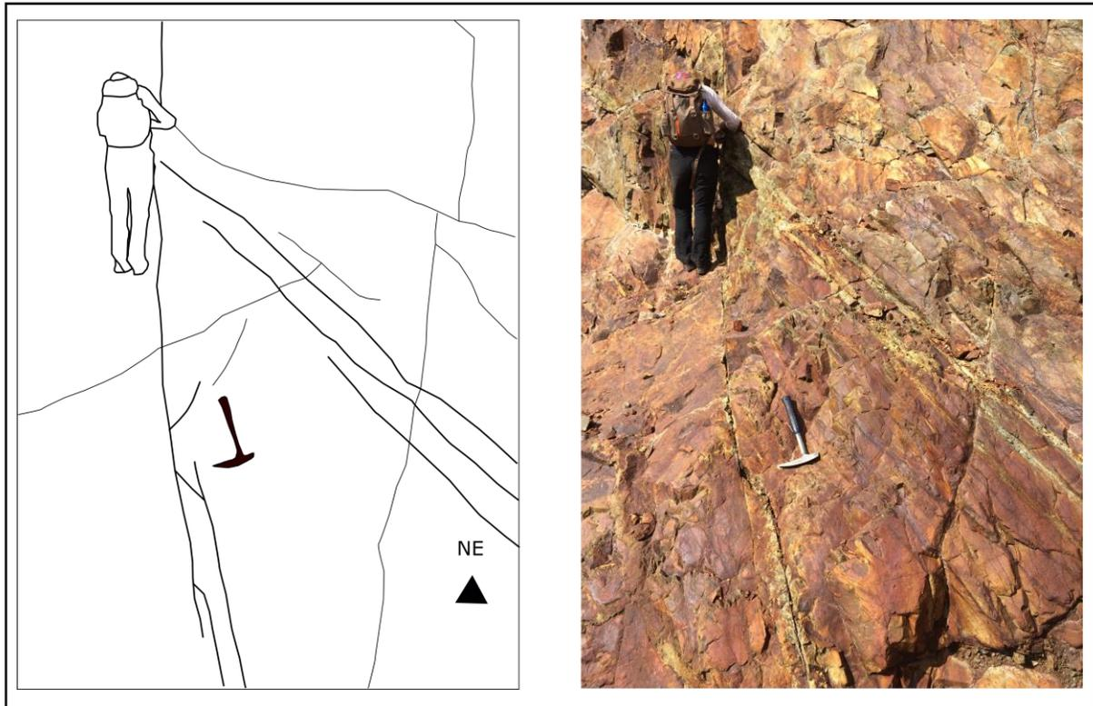
Figura 3-38: Medición vetillas de pirita y halo de óxidos de Fe, vista en perfil del dominio 4 y rumbo NE
