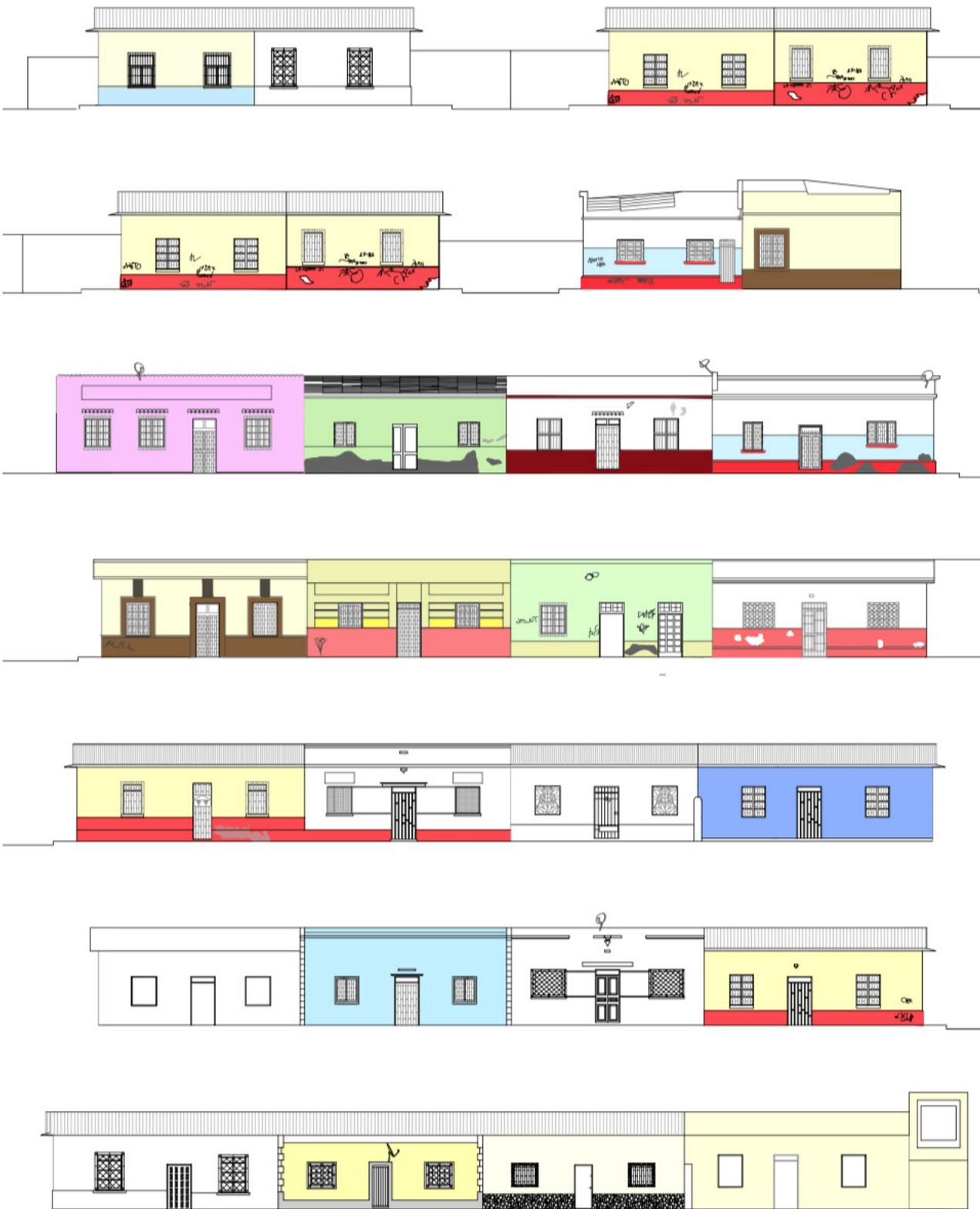
Levantamiento planimétrico de las fachadas del conjunto, se aprecian las diversas intervenciones presentes en el conjunto.
