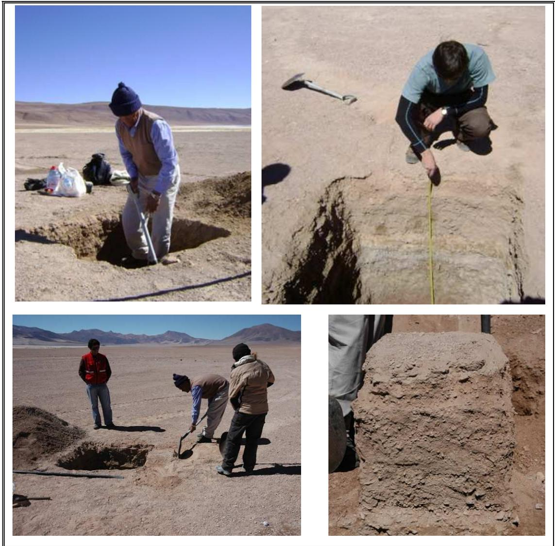
Figura 1-5: Toma de muestra en la cuenca del salar de Huasco para el montaje experimental.
