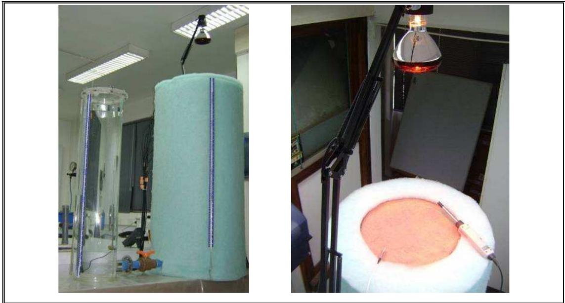
Figura 1-6: Instalación experimental: a) aislamiento de columna de suelo; y b) superficie de la columna con lámpara infrarroja.
