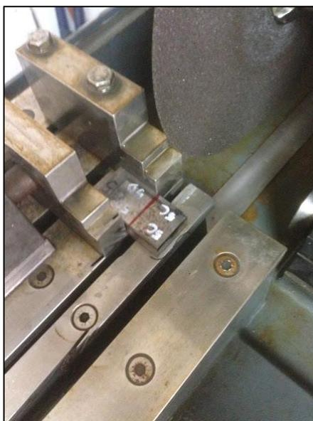
**Figura 4-3. Corte transversal de probeta de NCI transformada. Fuente: Elaboración propia.**
