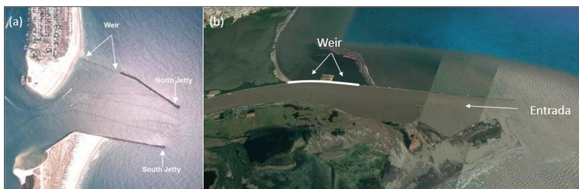
Figura 6-24. (a) Ejemplo real de la aplicación de Weir Jetty en Masonboro Inlet (Carolina del Norte). Fuente: tomado de Seabergh and Thomas (2002). (b) Ubicación del Weir Jetty dentro del dominio de estudio para el desarrollo del experimento propuesto. Fuente: tomado y adaptado de Google Earth.
