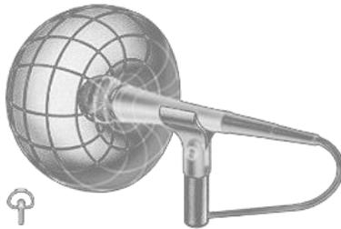
Ilustración 4: Diagrama de un micrófono cardioide.
