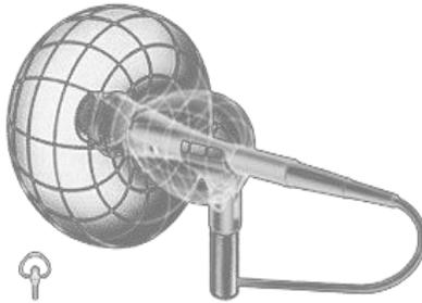
Ilustración 5: Diagrama de un micrófono supercardioide.
