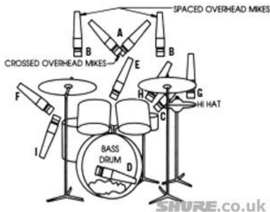
Ilustración 7: Diagrama de microfoneo de la batería, vista frontal.
