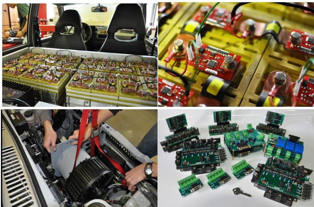
Figura 8-3: Baterías, ecualizadores, montaje del motor eléctrico, sensores y electrónica.
