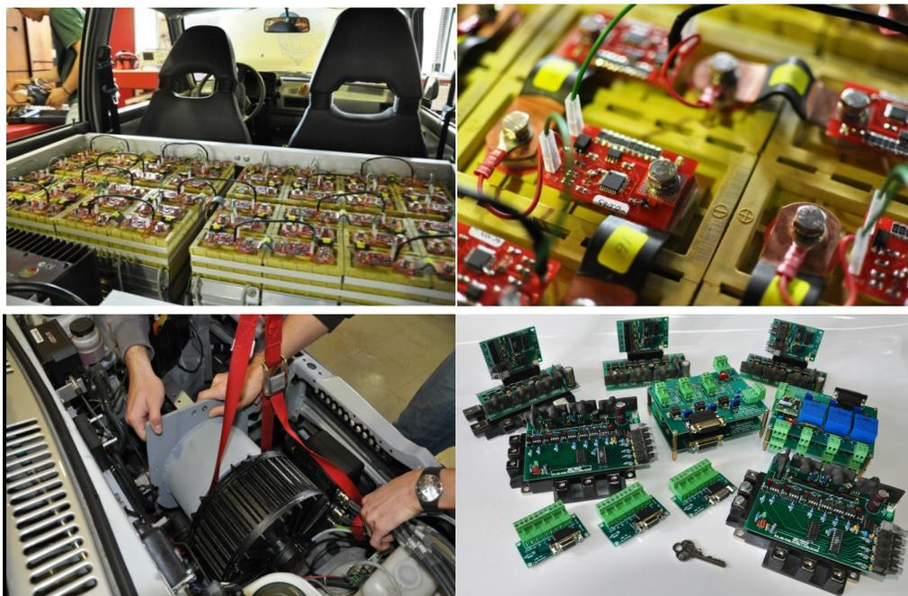
Figura M.7: Baterías, ecualizadores, montaje del motor eléctrico, sensores y electrónica.
