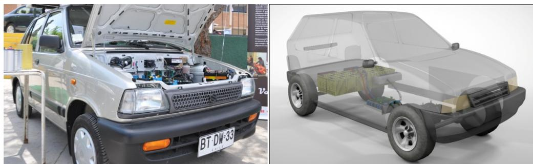
Figura 8-1: Vehículo Suzuki Maruti convertido a Eléctrico.
