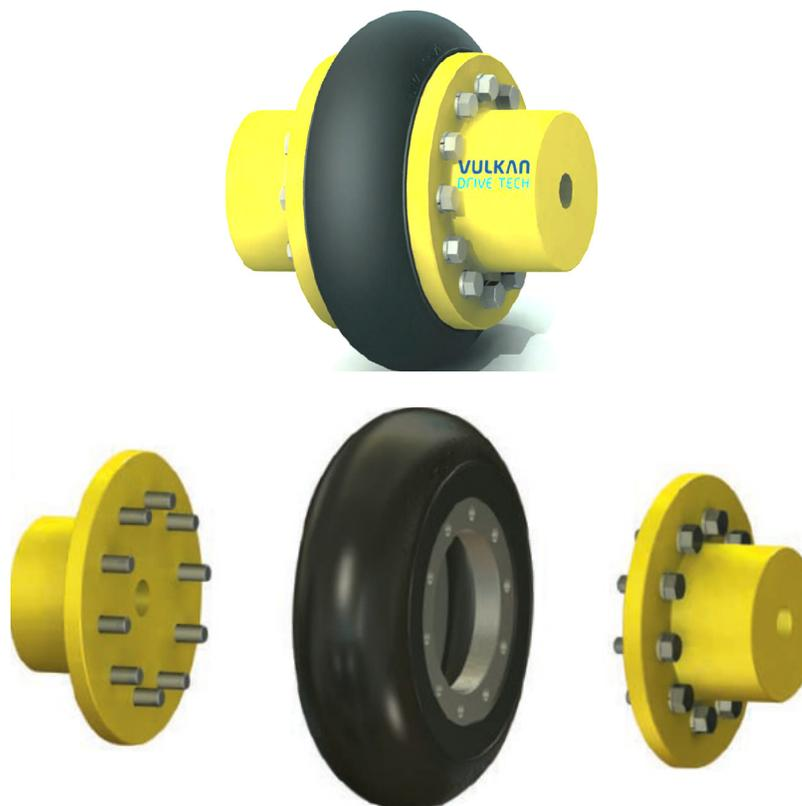
Figura H.3: Acoplamiento utilizado: Speflex SPA # 6 (Altamente Elástico) de la compañía Vulkan (Torque Nominal: 100Nm / Velocidad máxima: 5000rpm).
