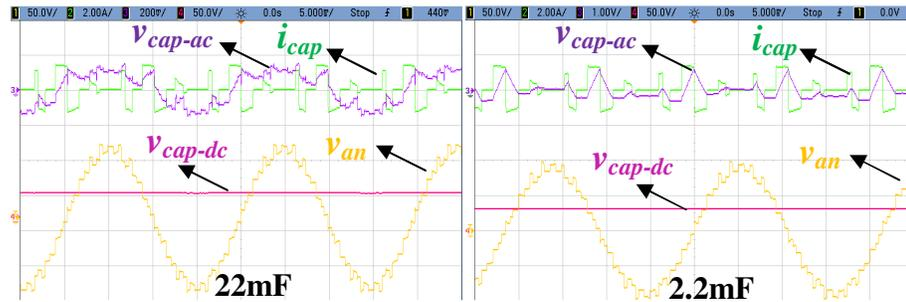
Figura 7-22: Voltaje y corriente del capacitor flotante en una fase con 22 y 2.2 mF.
