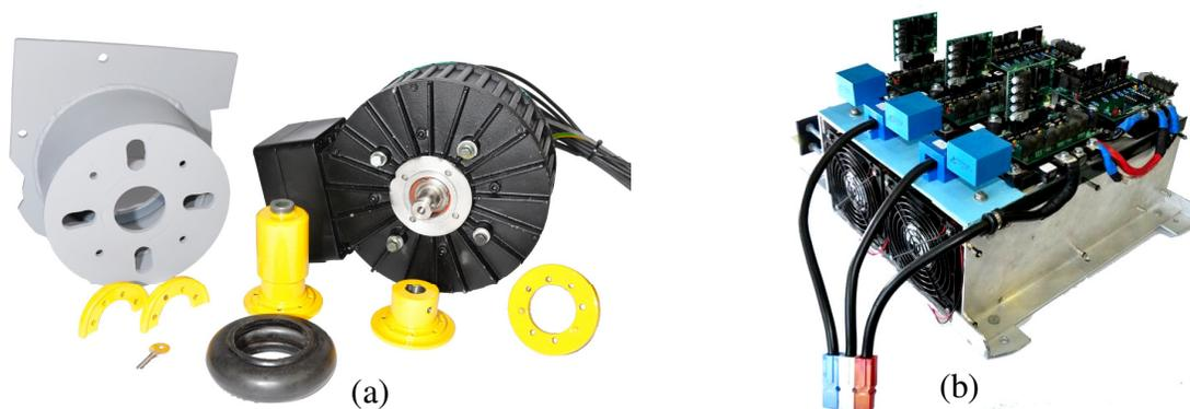
Figura 8-4: (a) Motor PMSM con su soporte y acoplamiento. (b) Convertor Multinivel.
