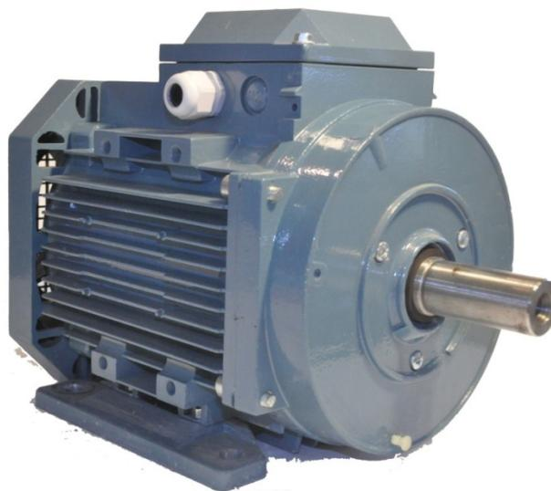
Figura F.3: Motor de Inducción Jaula de Ardilla ABB n°2.
