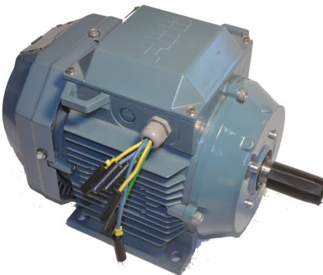
Figura F.2: Motor de Inducción Jaula de Ardilla ABB n°1.
