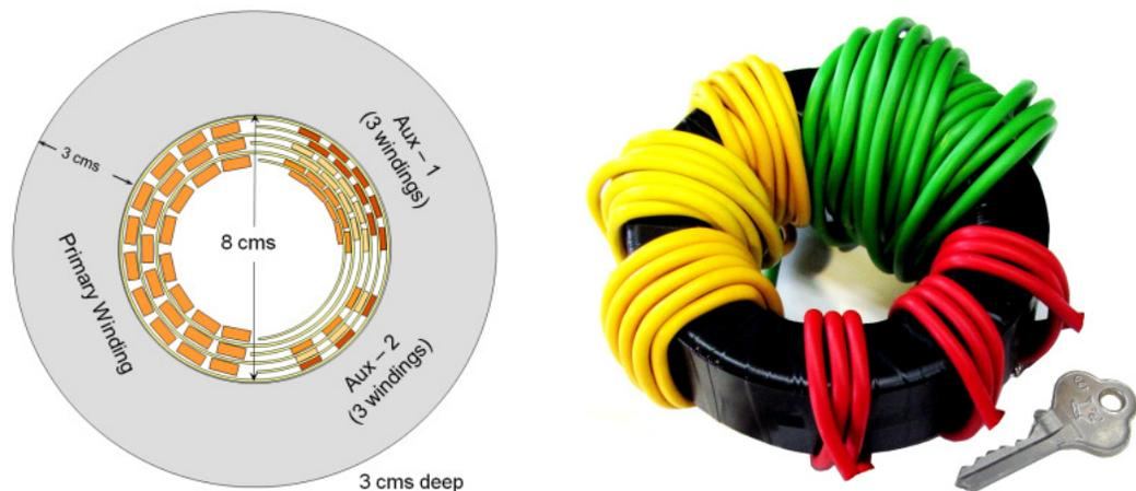
Figura 4-14: Transformador toroidal de ferrita para un convertor de 100kW.
