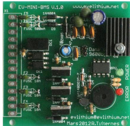
Figura N.3: *Battery Management System* (BMS) utilizado para monitorear los voltajes y temperaturas de cada celda de litio, y actuar desconectando los sistemas en caso de falla.
