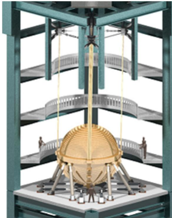
FIGURA 2.3. Amortiguador de masa sintonizado del Taipei 101, Taiwán. Fuente: [http://en.wikipedia.org/wiki/Taipei\\_101](http://en.wikipedia.org/wiki/Taipei_101)
