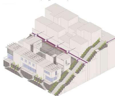
Figura 3.14: Sistema de convergencia y riego de aguas grises
