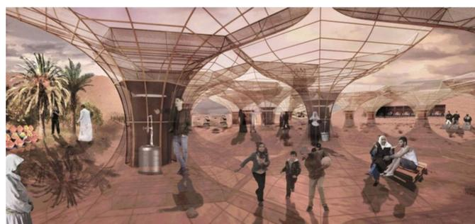
Figura 3.11: Espacio común sombreado a partir de la disposición de atrapanieblas para el abastecimiento de agua inmediato.
