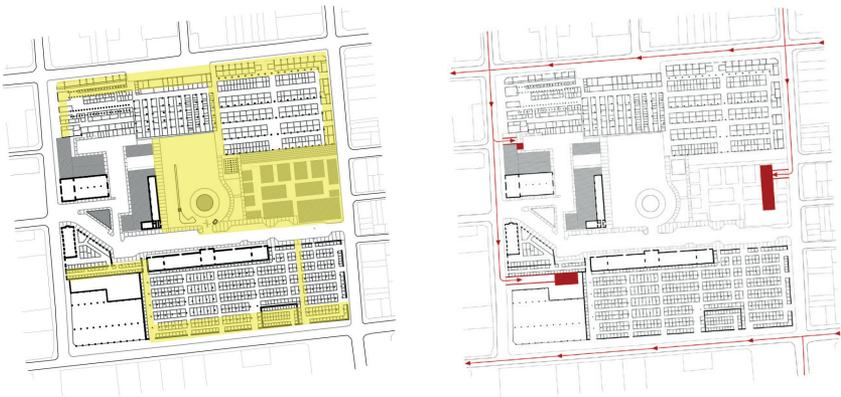
*Fig. 68: Planta esquemática del área de intervención del proyecto en el primer nivel de calle. Planta que indica los nuevos accesos vehiculares evitando la utilización del automóvil en el centro de la manzana. Elaboración propia.*
