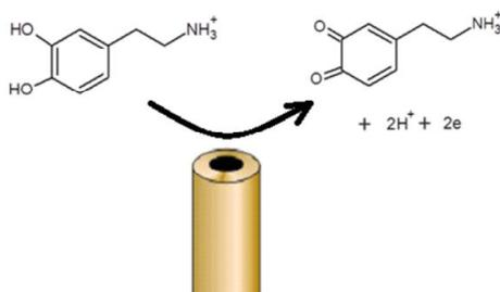
**Figura 4:** Esquema de la detección electroquímica de dopamina a la quinona respectiva, mediante un mecanismo de dos electrones.
