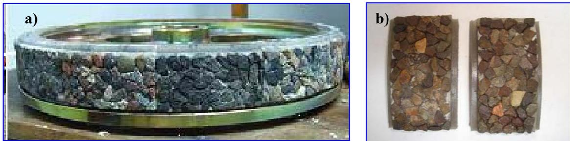
Figura II-5. a) Rueda de ensayo b) Probetas para ensayo.
