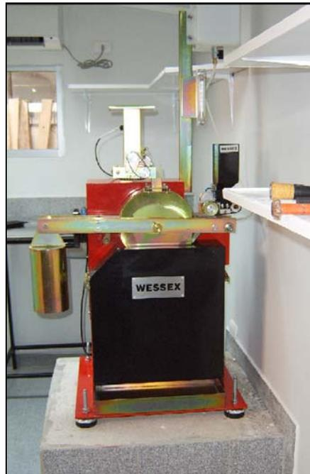
Figura II-3: Máquina de Pulimento Acelerado.
