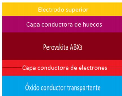
**Figura 2.** Estructura básica de una celda solar basada en perovskitas. Donde el óxido conductor transparente puede ser ITO o FTO, la capa conductora de electrones generalmente son semiconductores de tipo n ( $\text{TiO}_2$ ,  $\text{ZnO}$ , etc.), la capa conductora de huecos se emplean polímeros, materiales carbonáceos, entre otros y como electrodo superior generalmente se emplean metales nobles como el oro y la plata.
