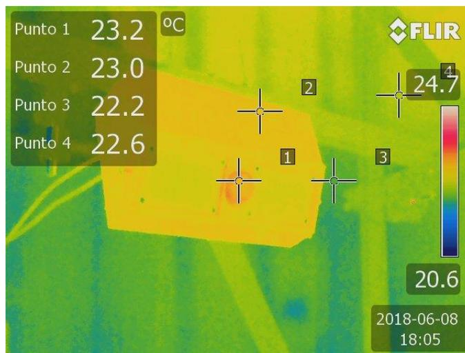
Figura 3.30 Fotografía infrarroja de la cámara de metrología en su caja contenedora montada en la estructura de aluminio. El punto 1 corresponde a la cara externa del objetivo, el punto 2 corresponde al cuerpo de la caja de metrología, el punto 3 y 4 corresponden al ambiente reflejado en dos superficies distintas.
