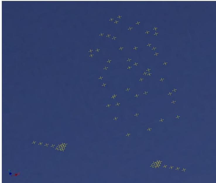
Figura 2.14 Nube de puntos generada para la Interfaz Telescopio-Instrumento. Se visualiza en el software Autodesk Inventor, donde es posible mover y analizar punto a punto sin intervenir la configuración adquirida en V-Stars.
