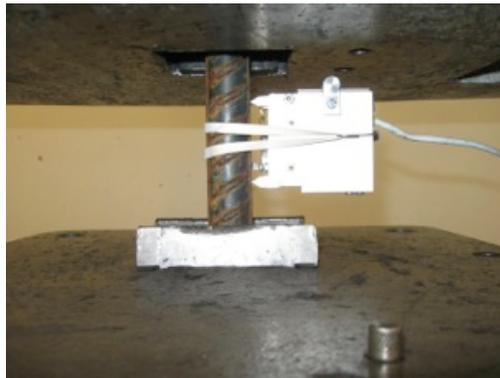
Figura A-2 Extensómetro de 50 mm de apertura
