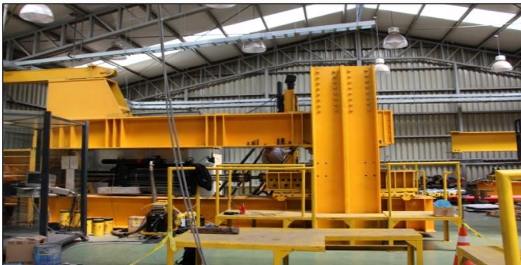
Figura 4-12: Marco de carga del laboratorio de ensayos dinámicos de DICTUC
