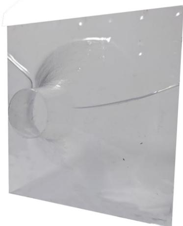
12 - Moldes termoformados de las perforaciones
