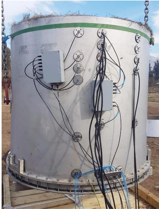
*Figura 2: Lisímetro de pesada de gran escala en su momento de instalación (durante periodo de mediciones, las malezas en el interior fueron removidas).*
