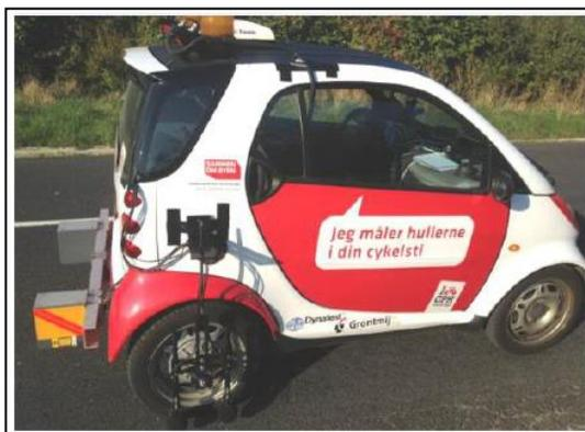
**Figura 2-2: Vehículo equipado con un Perfilómetro Láser. Fuente: Kohler (2015)**
