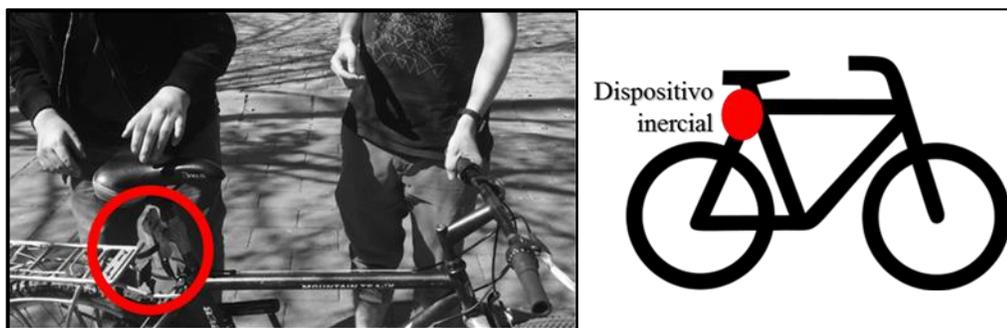
**Figura 3-2: Diagrama de ubicación del dispositivo inercial**
