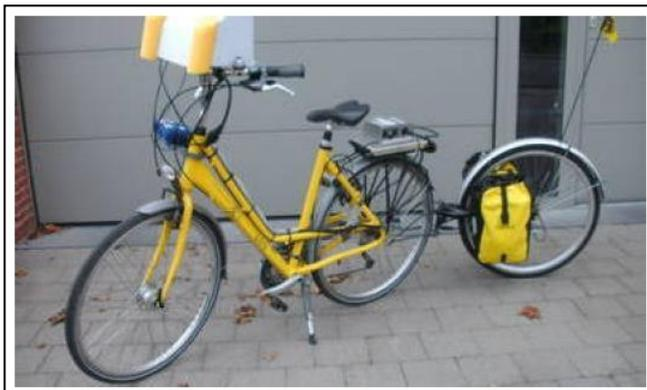
**Figura 2-1: Bicicleta equipada para medir la condición del pavimento. Fuente: Martens (2011)**
