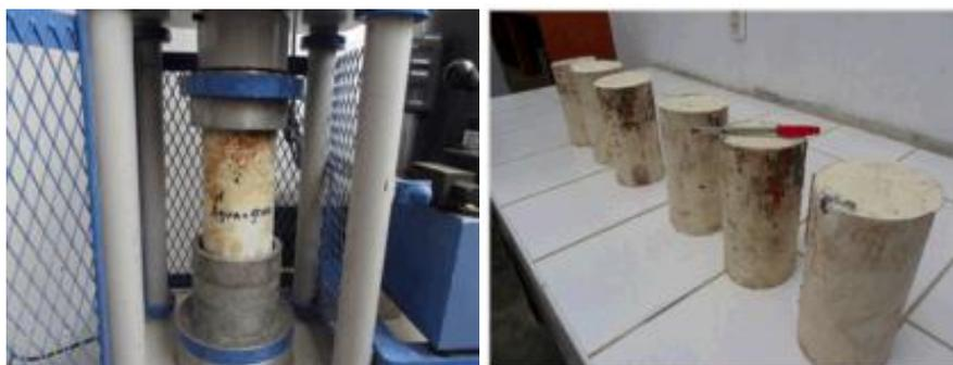
Figura 54: Prueba UCS en resina GEOFLEX (información interna Orica Chile)
