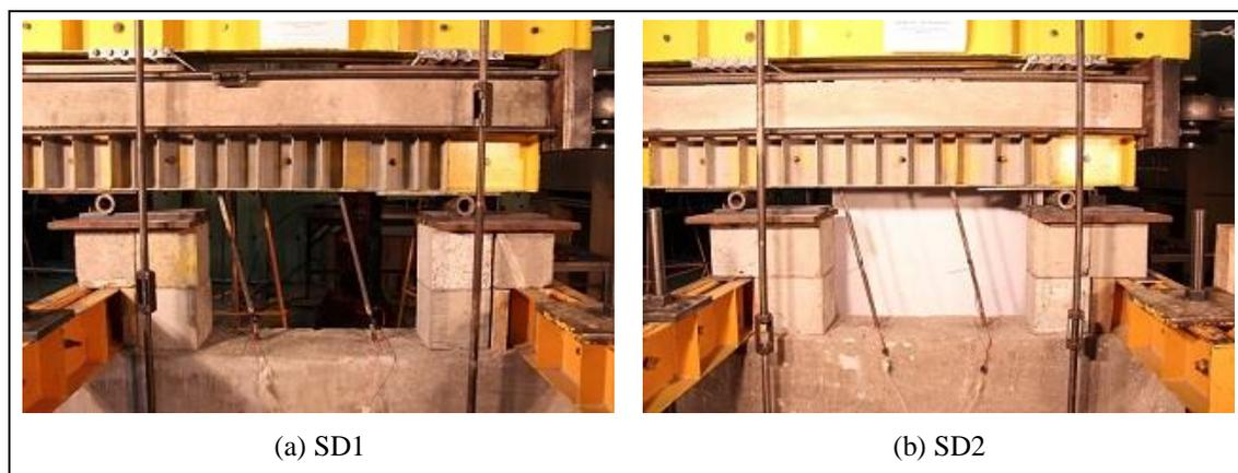
Figura 4.6: Fotografías en el instante de desplazamiento máximo de los especímenes SD1 y SD2
