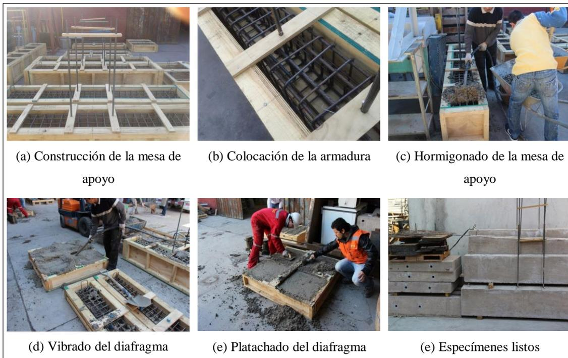
Figura 3.5: Construcción de los especímenes
