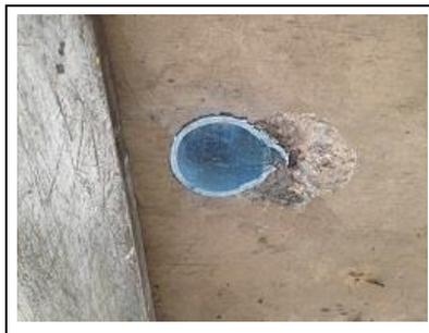
Figura 4.11: Daño generado en la superficie inferior de la losa debido al contacto con las barras sísmicas en el espécimen SD3
