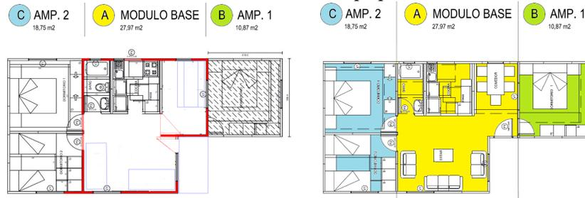
**Ilustración 12. Modelo de vivienda TECNOPANEL en SIP en modelo ajustado incremental ABC.**
