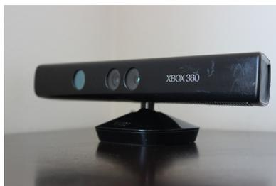
Figura 3: Cámara Kinect, desarrollada por Microsoft en 2010. Permite reconocer el movimiento de todo el cuerpo en 3D.
