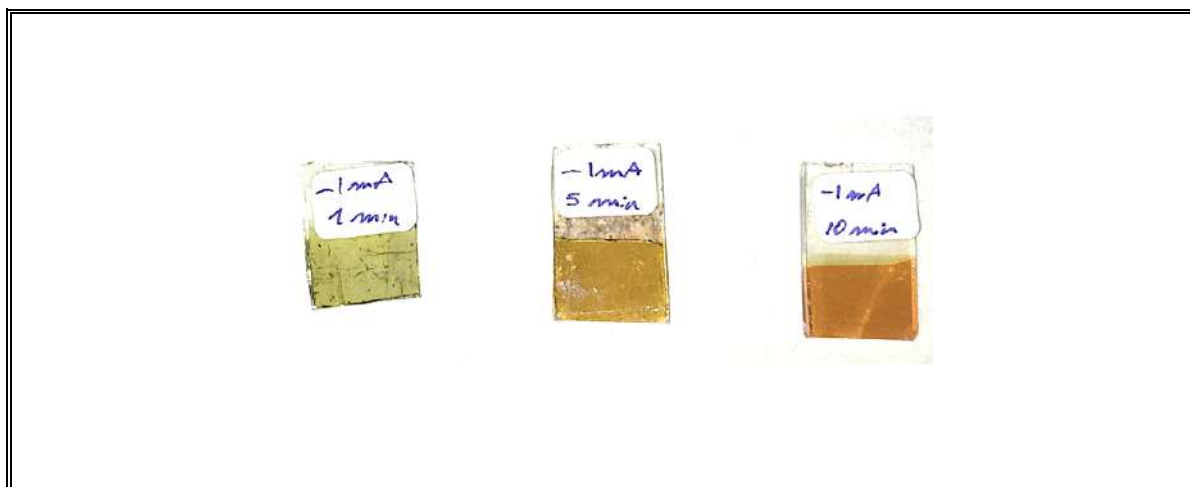
Figura 2.3: Apariencia física de electrodos, luego de realizar el depósito electroquímico de \text{Cu}_2\text{O} a tiempos de 1, 5 y 10 minutos. Formación de electrodos CTF
