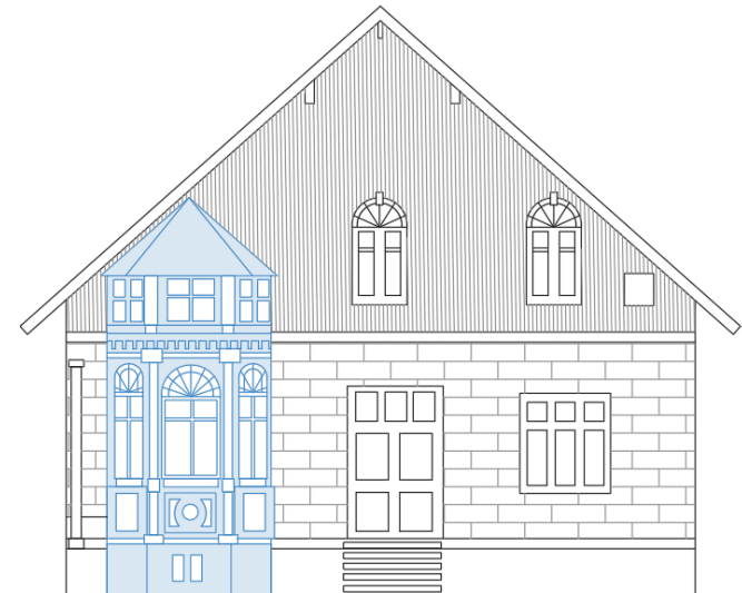
Figura 73. Elevación de casa Von Stillfried, se representa en azul la galería acristalada. Fuente: Elaboración propia en base Conjuntos Urbanos Histórico-Arquitectónicos, Valdivia, S XVIII-XIX.
